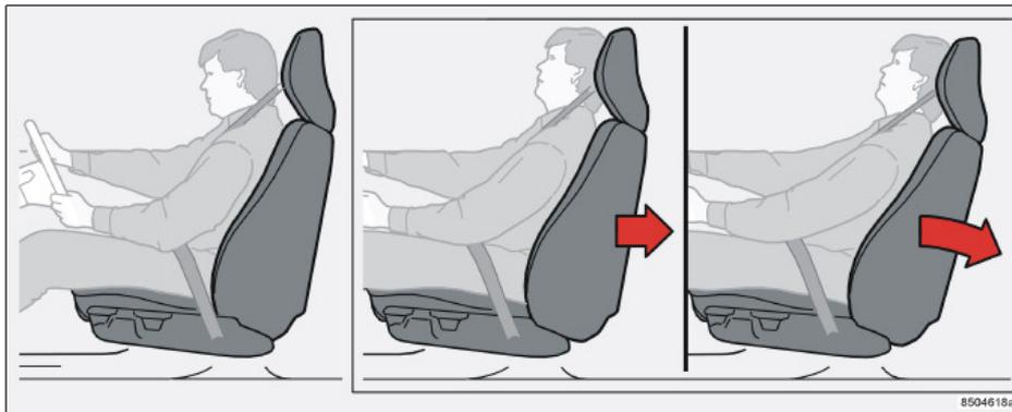
Das WHIPS-System (Whiplash Protection System) besteht aus energieaufnehmenden Rückenlehnen und speziell für das System entwickelten Kopfstützen an beiden Vordersitzen. Das System wird durch einen Heckaufprall aktiviert, wobei Aufprallwinkel, Geschwindigkeit und Eigenschaften des auffahrenden Fahrzeugs ausschlaggebend sind.
