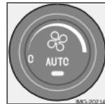
Die **AUTO**-Funktion übernimmt die automatische Regelung der Klimaanlage, so dass die gewählte Temperatur erreicht wird. Die automatische Funktion steuert Wärme, Klimaanlage, Gebläsegeschwindigkeit, Umluftfunktion und Luftverteilung. Bei Auswahl von einer oder mehreren manuellen Funktionen werden die übrigen Funktionen weiterhin automatisch gesteuert. Bei einem Druck auf **AUTO** werden sämtliche manuellen Einstellungen deaktiviert. Im Display erscheint **AUTOM. KLIMA**.
