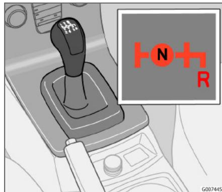
Legen Sie den Rückwärtsgang nur ein, wenn das Fahrzeug stillsteht. Der Wählhebel muss zuerst in die Neutralstellung **N** bewegt werden, bevor der Rückwärtsgang eingelegt werden kann. Der Rückwärtsgang kann aufgrund der Rückwärtsgangsperr nicht direkt aus dem fünften Gang eingelegt werden.
