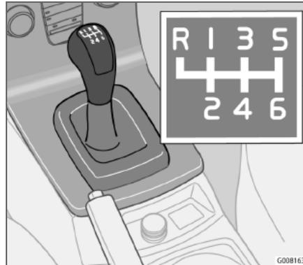
Drücken Sie das Kupplungspedal bei jedem Schaltvorgang ganz durch. Nehmen Sie zwischen den Schaltvorgängen den Fuß vom Kupplungspedal. Folgen Sie dem Schaltschema. Für eine wirtschaftliche Fahrweise möglichst oft in möglichst hohen Gängen fahren.
