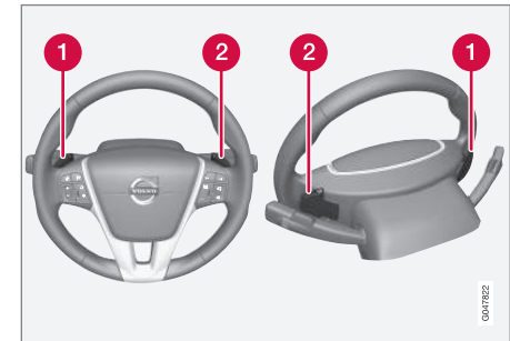
Die beiden "Schaltwippen" des Lenkrads.
