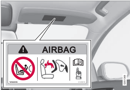
Möglichkeit 1: Airbagaufkleber an der Sonnenblende auf Beifahrerseite.
