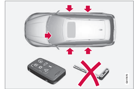
Verriegelungspunkte für Transponderschlüssel ohne Schlüsselblatt und aktivierter Geheimverriegelung.
