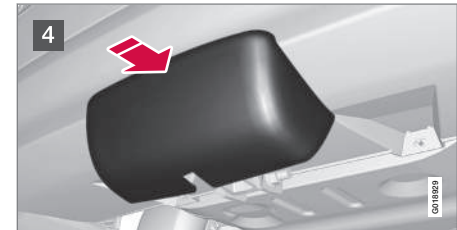
4 Die Schutzkappe aufschieben, bis sie festschnappt.
