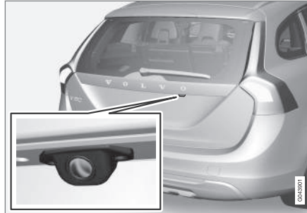
Position der Kamera am Öffnungsgriff.
