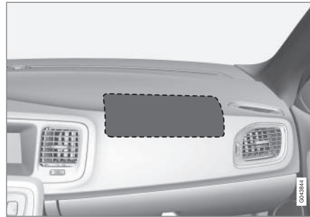
Position des Beifahrerairbags in Linkslenkern.
