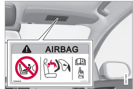
Möglichkeit 1: Airbagaufkleber an der Sonnenblende auf Beifahrerseite.
