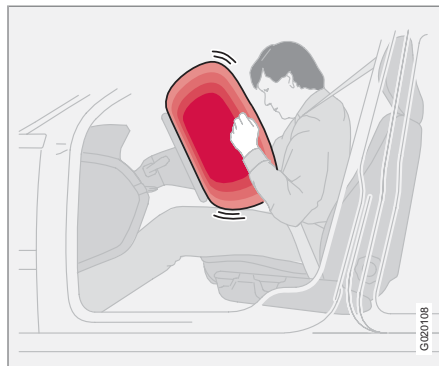
Position des Beifahrerairbags, Linkslenker bzw. Rechtslenker.
