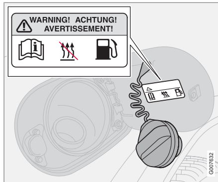
Warnaufkleber auf der Kraftstofftankklappe.
