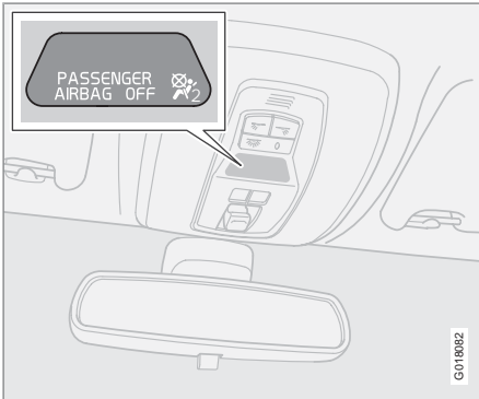
Anzeige, die darüber informiert, dass der Beifahrerairbag (SRS) deaktiviert ist.
