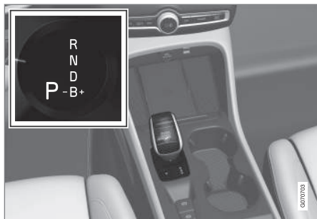
Wählhebel und Schaltmuster auf dem Fahrerdisplay
