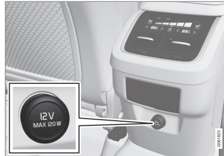
12-V-Steckdose in der Tunnelkonsole, Rücksitz.
