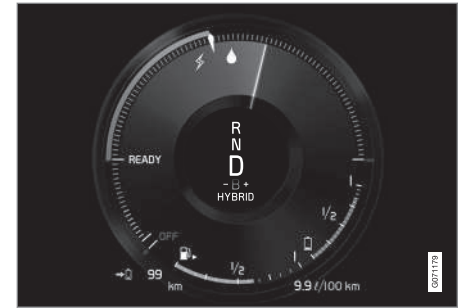
Fahrerdisplay bei Antrieb durch Elektro- und Verbrennungsmotor.
