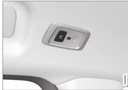
Fahrzeuge mit Panoramdach* verfügen beidseits des Dachs über je ein Leuchtenmodul. 7
