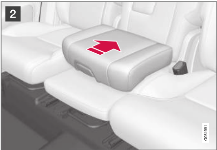
2 Damit die Sitzerhöhung einrastet, diese nach hinten drücken.
