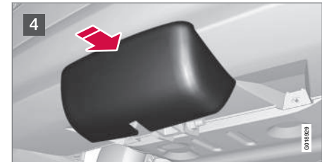
4 Die Schutzkappe aufschieben, bis sie festschnappt.
