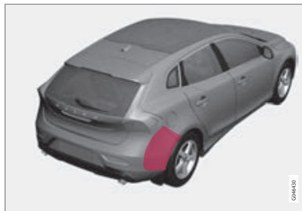
Anordnung der BLIS- und CTA-Sensoren. 1
