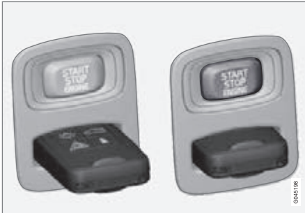
Zündschloss mit herausgezogenem/ingedrücktem Transponderschlüssel.
