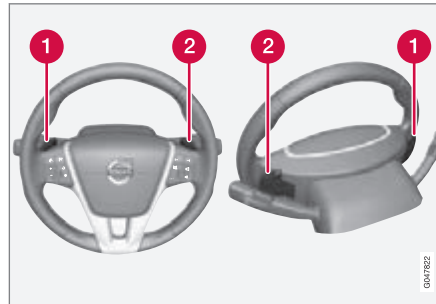
Die beiden "Schaltwippen" des Lenkrads.
