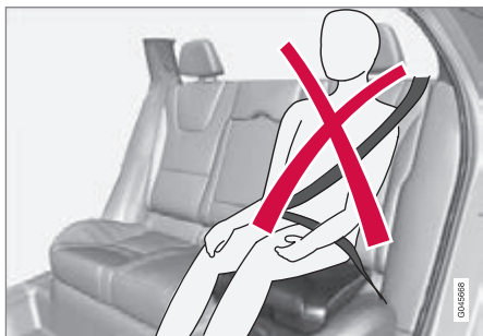
Falsche Position, die Kopfstütze muss auf derselben Höhe platziert sein wie der Kopf und der Gurt darf nicht unterhalb der Schulter verlaufen.
