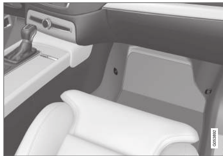
Lage der Befestigungspunkte für den Vordersitz
