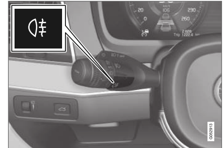
Taste für Nebelschlussleuchte.
