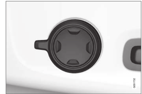
Seitlich am Sitzpolster angebrachter Multifunktionsschalter.
