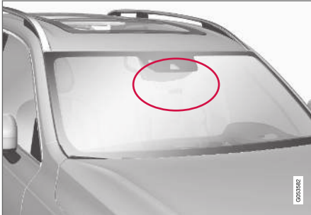
Platzierung der Kameraeinheit.
