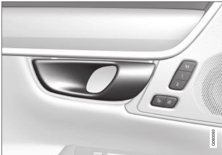
Griff zum alternativen Entriegeln der Tür 12 .
