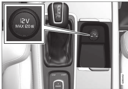
12-V-Steckdose in der Tunnelkonsole, vorn.
