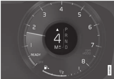
Schaltanzeige auf dem 12-Zoll-Fahrerdisplay*.
