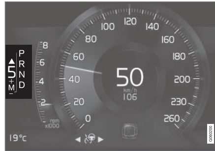
Schaltanzeige auf dem 8-Zoll-Fahrerdisplay bei großem Wählhebel.
