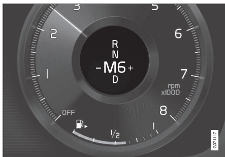
Schaltmuster auf dem Fahrerdisplay bei kleinem Wählhebel.
