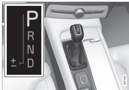
Großer Wählhebel und Schaltmuster auf dem Fahrerdisplay.
