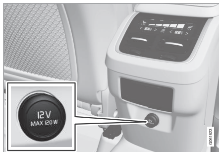
12-V-Steckdose in der Tunnelkonsole, Rücksitz.
