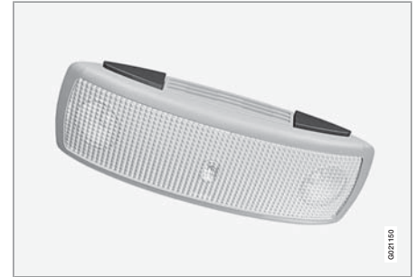
Hintere Deckenbeleuchtung in Fahrzeugen ohne Panoramadach.
