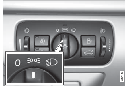
Lichtschalter in Stellung für Positionsleuchten/Standlicht.
