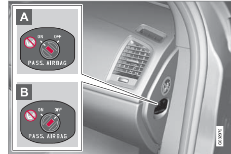
Position des Schalters.
