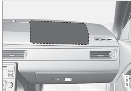
Position des Beifahrerairbags in Linkslenkern.
