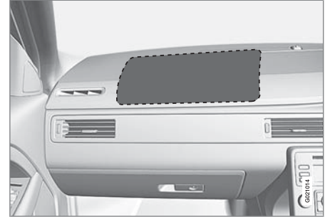
Position des Beifahrerairbags in Rechtslenkern.
