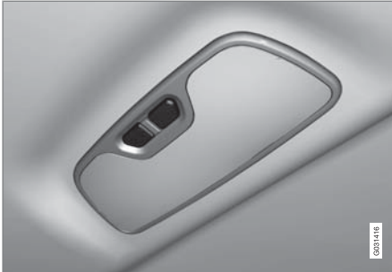
Hintere Deckenbeleuchtung in Fahrzeugen mit Panoramadach.
