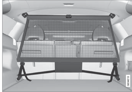
Das Schutznetz wird an vier Befestigungspunkten montiert.
