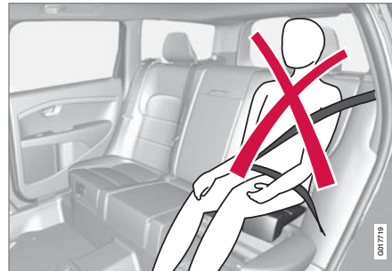
Falsche Position, der Kopf darf nicht über die Kopfstütze hinausragen und der Gurt darf nicht unterhalb der Schulter verlaufen.
