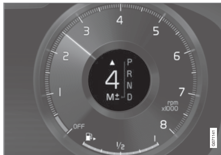
Schaltanzeige auf dem 12-Zoll-Fahrerdisplay bei großem Wählhebel*.
