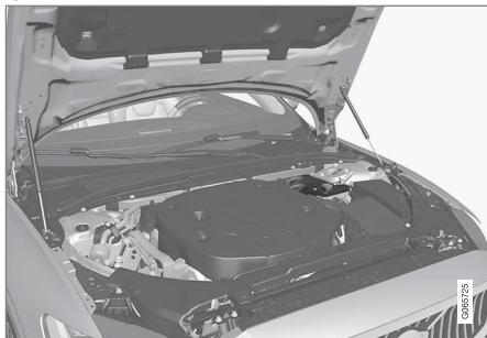
Die 12 V-Unterstützungsbatterie befindet sich im Motorraum.
