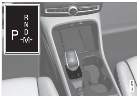
Kleiner Wählhebel und Schaltmuster auf dem Fahrerdisplay.
