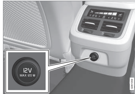
12-V-Steckdose in der Tunnelkonsole, Rücksitz.
