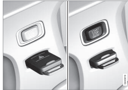
Zündschloss mit herausgezogenem/ingedrücktem Transponderschlüssel.
