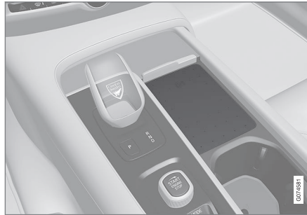
Drahtlos-Telefonladegerät in der Tunnelkonsole.
