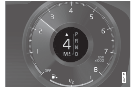
Schaltanzeige auf dem 12-Zoll-Fahrerdisplay bei großem Wählhebel*.
