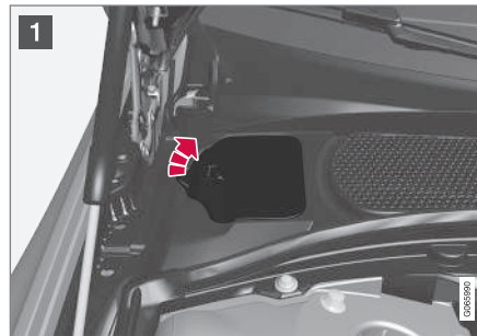
Ausgleichsbehälter für die Kühlanlage
