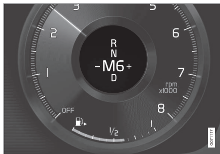
Schaltanzeige auf dem 12-Zoll-Fahrerdisplay bei kleinem Wählhebel*.
