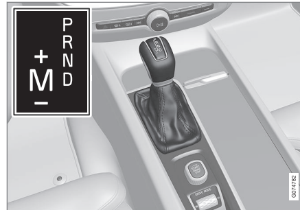
Großer Wählhebel und Schaltmuster auf dem Fahrerdisplay.
