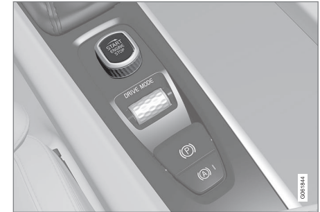
Startschalter auf der Tunnelkonsole.
