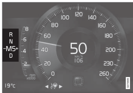
Schaltanzeige auf dem 8-Zoll-Fahrerdisplay bei kleinem Wählhebel.
