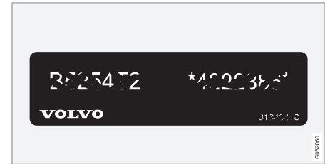
4 Beschilderung für Motorcode und Seriennummer des Motors. Für bestimmte Motorisierungen gibt es keinen Aufkleber, in diesem Fall kann der eingravierte Motorcode stattdessen direkt auf dem Motor abgelesen werden.
