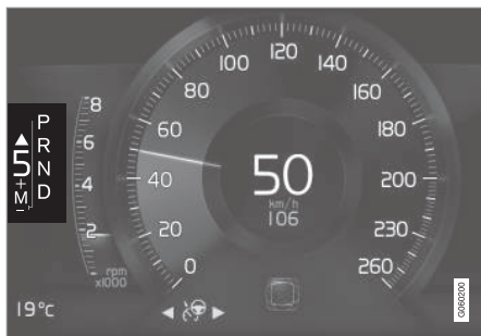
Schaltanzeige auf dem 8-Zoll-Fahrerdisplay bei großem Wählhebel.
