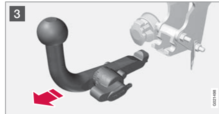
3 Den Verriegelungsknopf vollständig bis zum Anschlag weiterdrehen, herunterdrücken und gleichzeitig das Kugelteil nach hinten und oben herausziehen.
