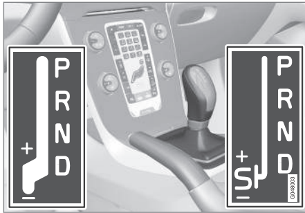
D: Automatische Gangstellungen. +/-: Manuelle Gangstellungen. S: Sportmodus*. 6
