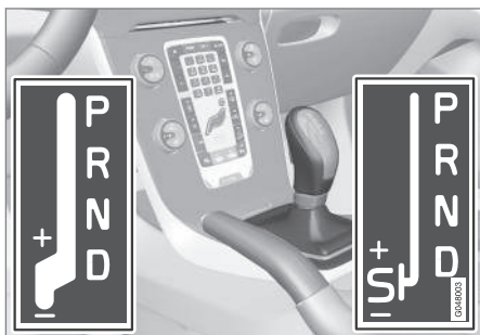
D: Automatische Gangstellungen. +/-: Manuelle Gangstellungen. S: Sportmodus*. 4
