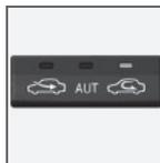
Wenn die Umluftfunktion eingeschaltet ist, leuchtet die rechte orangefarbene Lampe in der Taste<sup>1</sup>. Die Funktion wird gewählt, um zu verhindern, dass schlechte Luft,
