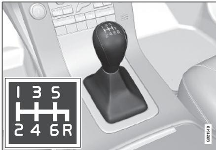
Das Kupplungspedal bei jedem Schaltvorgang ganz durchdrücken. Zwischen den Schaltvorgängen den Fuß vom Kupplungspedal nehmen. Dem Schaltschema folgen.
