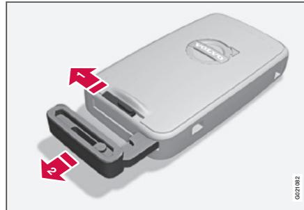
Die federbelastete Sperre zur Seite ziehen und gleichzeitig das Schlüsselblatt gerade nach hinten ziehen.
