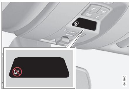
Anzeige in der Dachkonsole, die darauf aufmerksam macht, dass der Beifahrerairbag (SRS) aktiviert ist
