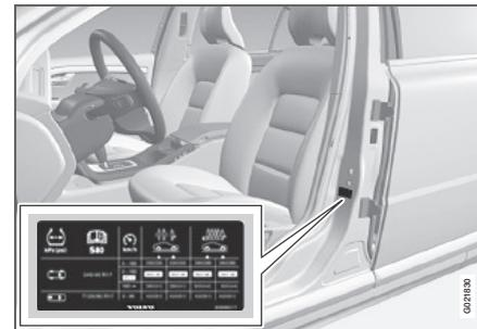
Auf dem Reifendruckaufkleber an der Türsäule auf der Fahrerseite (zwischen Vorder- und Fondtür) ist der bei unterschiedlicher Belastung und unterschiedlichen Geschwindigkeitsverhältnissen geltende Reifendruck angegeben. Der Reifendruck ist ebenfalls in der Reifendrucktabelle angegeben, siehe S. 215.
