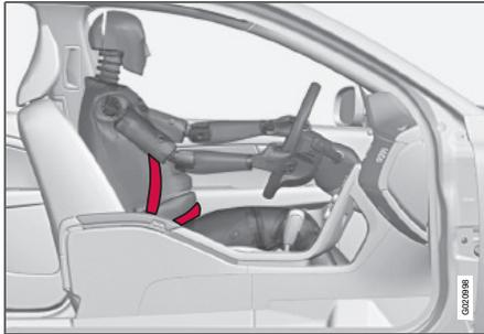
Der Sicherheitsgurt muss während der Schwangerschaft immer angelegt werden. Dabei ist es von äußerster Wichtigkeit, dass er korrekt angelegt wird. Der Sicherheitsgurt muss dicht an der Schulter anliegen, der Diagonaleil des Sicherheitsgurtes muss zwischen den Brüsten zur Seite des Bauches geführt werden.
