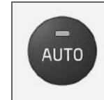
Die Autofunktion gibt es nur, wenn ECC im Fahrzeug installiert ist. Die Funktion regelt automatisch Temperatur, Klimaanlage, Gebläsegeschwindigkeit, Umluftfunktion und Luftverteilung.
