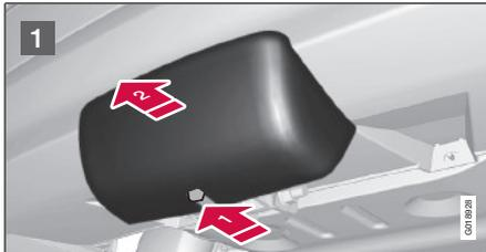
1 Die Schutzkappe entfernen. Dazu die Sperre
