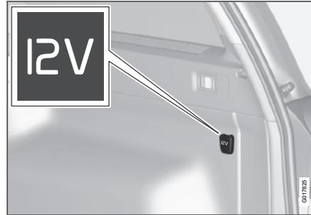
Den Deckel herunterklappen, um die Steckdose zu erreichen. Die Steckdose funktioniert unabhängig davon, ob die Zündung eingeschaltet ist oder nicht. Die Steckdose nur bei laufendem Motor verwenden, um eine Entladung der Batterie zu vermeiden.
