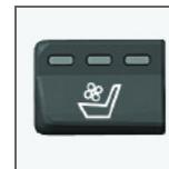
Die Vordersitzlüftung kann nur gewählt werden, wenn ECC im Fahrzeug installiert ist. Die Lüftungsanlage besteht aus Gebläsen in Sitzen und Rückenlehnen, die Luft durch den Sitzbezug saugen. Der Kühleffekt erhöht sich, je kälter die Innenraumluft ist.
