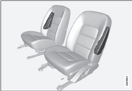
Ein Großteil der Aufprallstärke wird von SIPS (Side Impact Protection System) zu Trägern, Säulen, Boden, Dach und anderen Teilen der Fahrzeugkarosserie übertragen. Die Fahrer- und Beifahrerseitenairbags schützen den Brustkorb und den Hüftbereich und sind ein wichtiger Bestandteil von SIPS. Das SIPS-Airbagsystem setzt sich aus zwei Hauptkomponenten zusammen: Seitenairbag und Sensoren. Der Seitenairbag ist im Rückenlehnenrahmen des Vordersitzes eingebaut.
