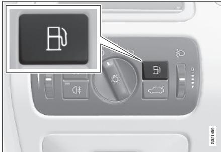
Der Motor muss abgestellt sein, bevor die Klappe geöffnet werden kann. Die Klappe mit der Taste im Schalterfeld Beleuchtung öffnen. Die Kraftstofftankklappe befindet sich am rechten Hinterkotflügel. Der Pfeil des Symbols
