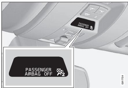
Anzeige in der Dachkonsole, die darauf aufmerksam macht, dass der Beifahrerairbag (SRS) deaktiviert ist
