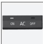
**ON:** Die Klimaanlage wird automatisch durch das System gesteuert. Auf diese Weise wird die einströmende Luft gekühlt und ausreichend entfeuchtet.
