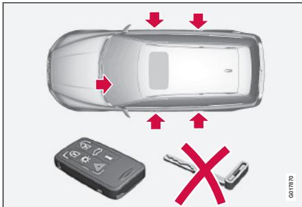
Verriegelungspunkte für Transponderschlüssel, **ohne** Schlüsselblatt und **mit** aktivierter Geheimverriegelung.
