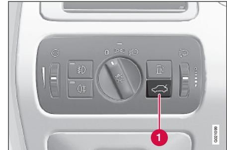
Zur Entriegelung der Heckklappe auf die Taste **1** am Schalferfeld Beleuchtung drücken.
