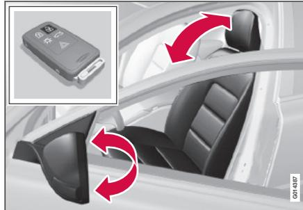
Wenn das Fahrzeug mit demselben Transponderschlüssel entriegelt und die Fahrertür geöffnet wird, nehmen der Fahrersitz und die Außenspiegel automatisch die im Schlüsselspeicher gespeicherten Positionen ein.
