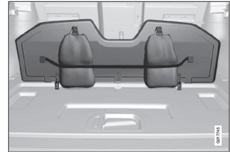
Tragetaschenhalter unter aufklappbarer Klappe im Boden
