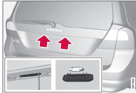
1. Die Schrauben mit einem Schraubendreher lösen.
