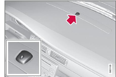
Eine Alarmanzeige am Armaturenbrett zeigt den Status der Alarmanlage an:
