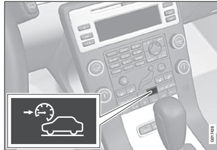
HDC wird mit einem Schalter auf der Mittelkonsole ein- bzw. ausgeschaltet. Eine Lampe in der Taste leuchtet, wenn die Funktion eingeschaltet ist. Wenn HDC arbeitet, leuchtet das Symbol
