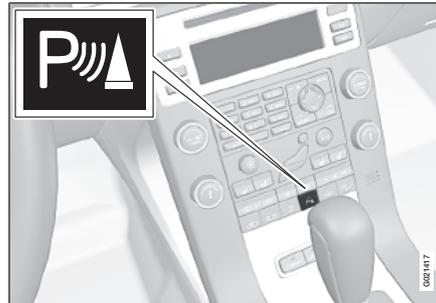
Das System wird automatisch beim Starten des Fahrzeugs eingeschaltet und die Ein/Aus-Lampe des Schalters leuchtet. Wird die Einparkhilfe mit der Taste ausgeschaltet, erlischt die Lampe.
