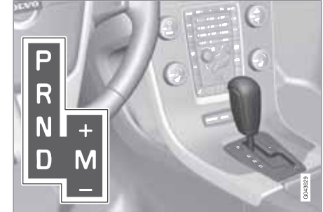
D: Automatische Gangstellungen. M (+/-): Manuelle Gangstellungen.
