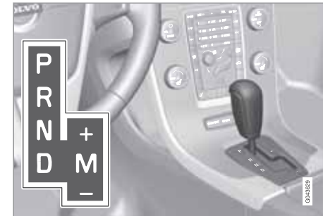
D: Automatische Gangstellungen. M (+/-): Manuelle Gangstellungen.
