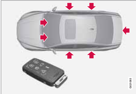
Verriegelungspunkte für Transponderschlüssel mit Schlüsselblatt.
