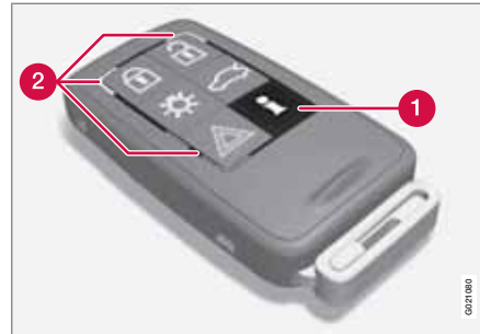
Transponderschlüssel mit PCC* - Personal Car Communicator.
