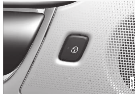
Verriegelungstaste mit Anzeigeleuchte an der Hintertür.
