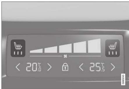
Anzeige und Bedienfeld der Sitzheizung auf dem hinteren Klima-Bedienfeld an der Tunnelkonsole.
