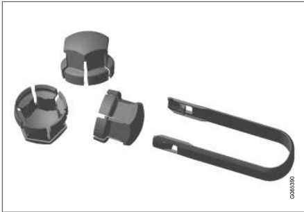
Ausbauwerkzeug für die Kunststoffkappen der Radmuttern.
