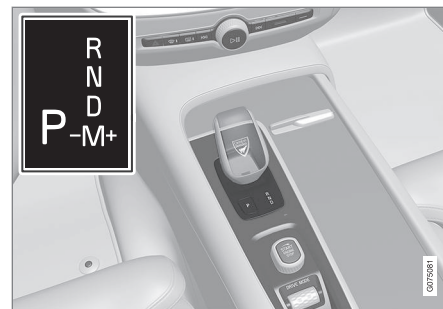
Kleiner Wählhebel und Schaltmuster auf dem Fahrerdisplay.
