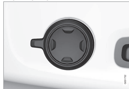
Seitlich am Sitzpolster angebrachter Multifunktionsschalter.
