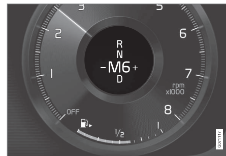
Schaltmuster auf dem Fahrerdisplay bei kleinem Wählhebel.
