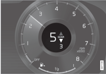
Schaltanzeige auf dem 12-Zoll-Fahrerdisplay*.
