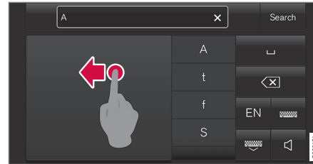
Streichen Sie über das Feld für die handschriftliche Texteingabe (1), um Zeichen im Textfeld (2) zu löschen.
