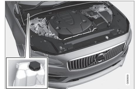
Ausgleichsbehälter der Kühlanlage, Rechtslenker
