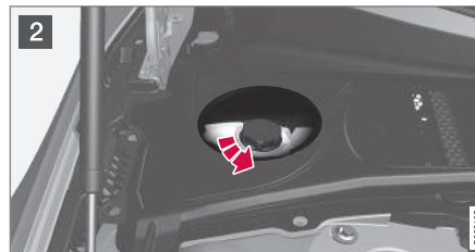
Ausgleichsbehälter der Kühlanlage, Rechtslenker
