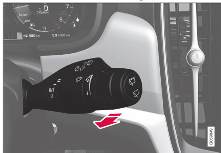
Waschfunktion, rechter Lenkradhebel.
