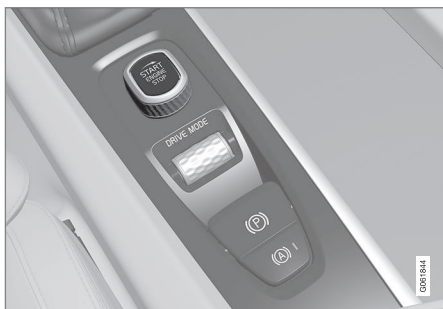
Startschalter auf der Tunnelkonsole.
