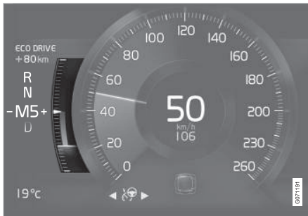
Eco-Anzeige auf dem 8-Zoll-Fahrerdisplay.
