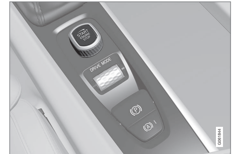
Startschalter auf der Tunnelkonsole.
