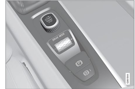
Startschalter auf der Tunnelkonsole.
