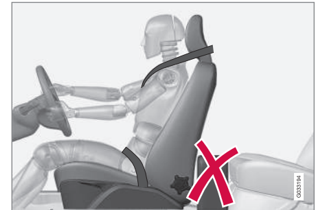
Keine Gegenstände auf dem Boden hinter dem Fahrer-/Beifahrersitz ablegen, die die Funktion des WHIPS-Systems behindern könnten.
