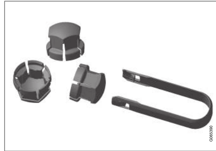
Ausbauwerkzeug für die Kunststoffkappen der Radmuttern.
