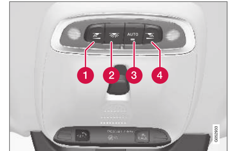
Bedienelemente in der Deckenkonsole für vordere Leseleuchten und Innenbeleuchtung.
