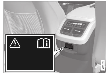
Steckdose in der Tunnelkonsole, Fond.
