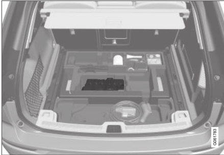
Die Startbatterie befindet sich im Kofferraum.
