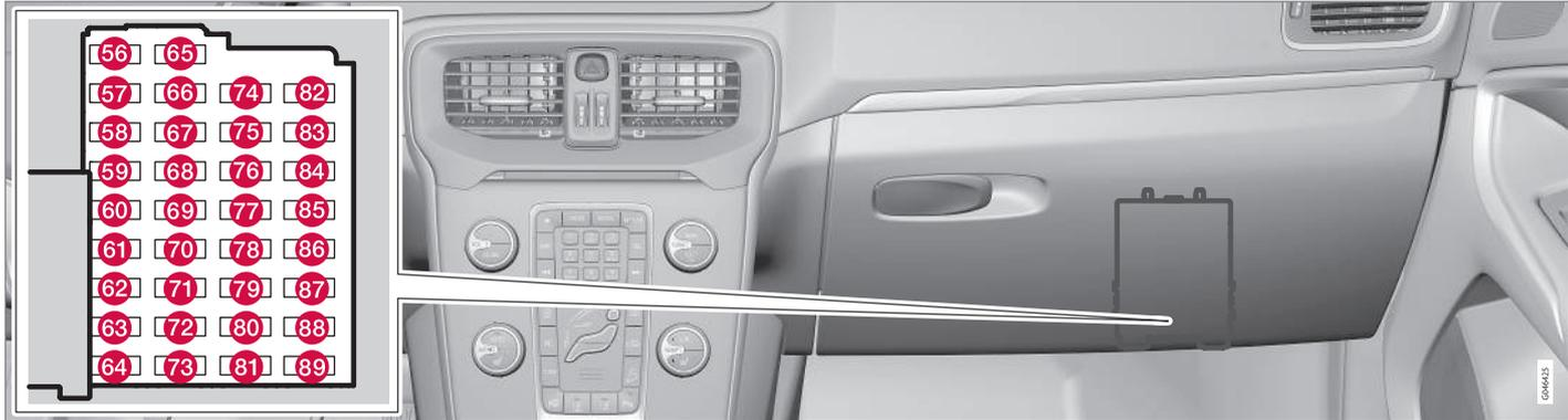
Auf der Deckelinnenseite der **Zentralelektrik** ist eine Zange befestigt, mit der Sicherungen einfacher herausgezogen und eingesetzt werden können.
