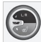
Die Temperatur auf der Fahrer- und auf der Beifahrerseite kann separat eingestellt werden. Drücken Sie wiederholt auf die **L/R**-Taste, um das Einstellen für die linke, die rechte oder beide Seiten
