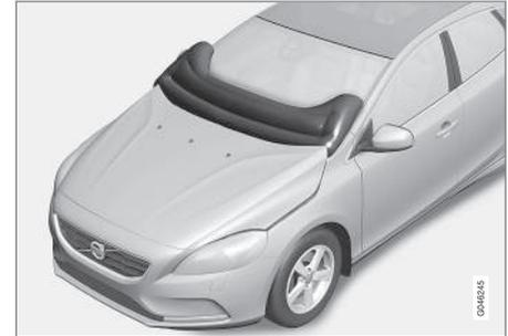
Der Fußgänger-Airbag (Pedestrian Airbag) ist windschutzscheibenseitig unter der Motorhaube montiert. Bei bestimmten Frontalzusammenstößen mit einem Fußgänger reagiert der Sensor in der vorderen Stoßstange und der Airbag wird aufgeblasen, wenn die Aufprallkraft als ausreichend groß beurteilt wird. Die Sensoren sind bei einer Geschwindigkeit von ca. 20-50 km/h (12-30 mph) und einer Umgebungstemperatur von -20-70 °C aktiv.
