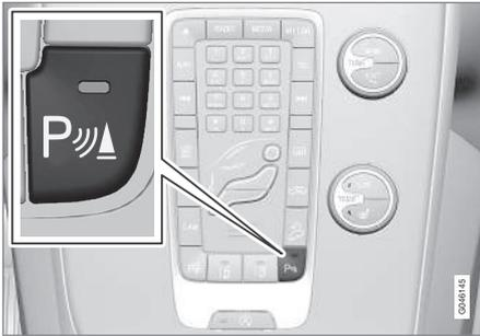
Ein/Aus der Sensoren der Einparkhilfe und von CTA<sup>30</sup>.
