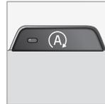
Die Start/Stop-Funktion wird automatisch aktiviert, wenn der Motor mit dem Schlüssel gestartet wird. Der Fahrer wird durch das Aufleuchten des Symbols für den Ein/Aus-Schalter im Kombinationsinstrument und durch das Leuchten des Ein/Aus-Schalters auf die
