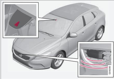
Kamera- und Radarsensor<sup>26</sup>.
