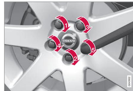
4. Die Radmuttern über Kreuz festziehen. Es ist wichtig, dass die Radmuttern mit den vorschrittmäßigen Anzugsmomenten angezogen werden. Das Anzugsmoment mit einem Drehmomentschlüssel überprüfen.
