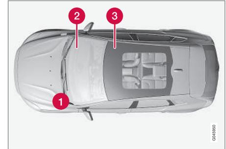
Anordnung der Zentralelektriken Linkslenker, bei Rechtslenkern wechselt die Zentralelektrik unter dem Handschuhfach die Seite.
