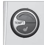
Mit dem Drehregler kann die Temperatur im Fahrzeuginnenraum eingestellt werden.
