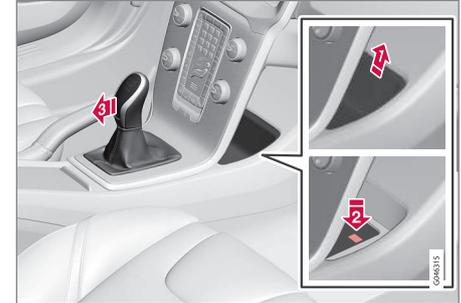
Wenn das Fahrzeug nicht gefahren werden kann, z.B. wenn die Batterie entladen ist, muss der Wählhebel aus der **P**-Stellung bewegt werden, damit das Fahrzeug bewegt werden kann.
