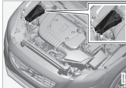
Beim Einfüllen sind die Anweisungen auf der Verpackung zu befolgen. Niemals nur Wasser nachfüllen. Die Gefriergefahr erhöht sich bei zu niedrigem bzw. zu hohem Kühlmittelanteil.
