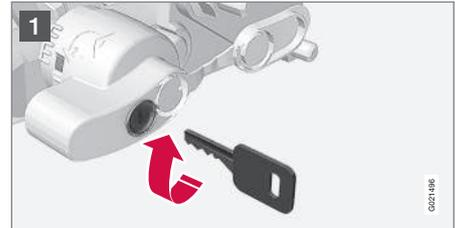
**1** Den Schlüssel hineinstecken und im Uhrzeigersinn drehen, um das Schloss zu entriegeln.
