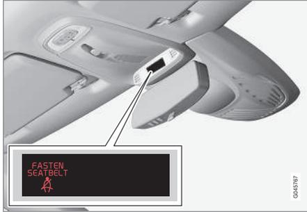
Das akustische Signal ist geschwindigkeitsabhängig und in bestimmten Fällen zeitabhängig. Das optische Signal befindet sich in der Dachkonsole und im Kombinationsinstrument (S. 66).
