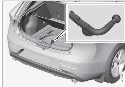
Bei Nichtverwendung ist die abnehmbare Anhängerkupplung<sup>17</sup> im Schaumgummiblock unter dem Kofferraumboden aufzubewahren.
