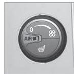
Mit dem Drehregler wird die Gebläsegeschwindigkeit erhöht oder gesenkt.
