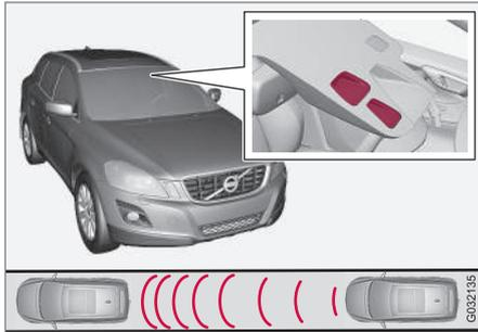
Sender- und Empfängerfenster des Lasersensors<sup>18</sup>.
