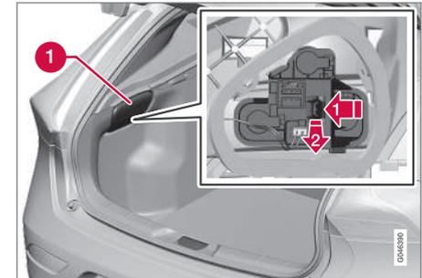
1. Die Klappe in der Verkleidung (1) auf jener Seite entfernen, auf der sich die defekte Glühlampe befindet.
