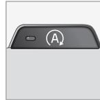
In bestimmten Situationen ist es wünschenswert, die automatische Start/Stop-Funktion vorübergehend abschalten zu können – dies erfolgt mit einem Druck auf diese Taste.
