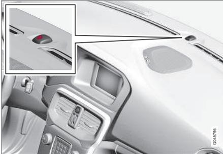
Gleiche Diode wie die der Verriegelungsanzeige (S. 166).
