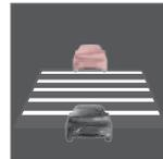
Nur wenn das Symbol das Bild eines anderen Fahrzeugs zeigt, wird der **Abstand** zum vorausfahrenden Fahrzeug durch den ACC geregelt.
