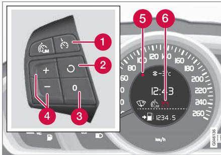
Tastenfeld des Lenkrads und Display in einem Fahrzeug mit Geschwindigkeitsbegrenzer<sup>9</sup>.
