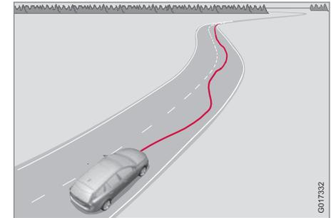
Eine Kamera erfasst die gemalten Seitenmarkierungen der Fahrbahn und vergleicht die Straßenführung mit den Lenkradbewegungen des Fahrers. Der Fahrer wird gewarnt, wenn das Fahrzeug der Fahrbahn nicht auf gleichmäßige Weise folgt.
