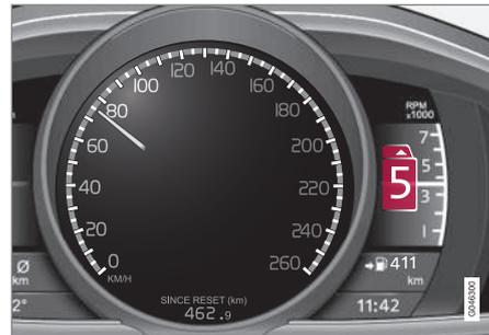
Kombinationsinstrument „Digital“ mit Schaltanzeige.
