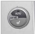
Die Auto-Funktion regelt automatisch die Temperatur (S. 138), Klimaanlage (S. 139), Gebläsegeschwindigkeit (S. 137), Umluftfunktion (S. 140) und die Luftverteilung (S. 132).
