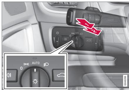
Lenkradhebel und Drehregler des Lichtschalters.
