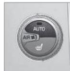
Mit dem Drehregler wird die Gebläsegeschwindigkeit erhöht oder gesenkt, **AUTO** wird ausgeschaltet. Bei der Wahl von **AUTO** wird die Gebläsegeschwindigkeit automatisch (S. 138) geregelt - die zuvor eingestellte Gebläsegeschwindigkeit wird außer Acht gelassen.
