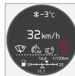
Beim Kombinationsinstrument "Analog" werden Gangstellungen und Anzeigepfeile in der Mitte angezeit.
