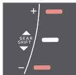
Schaltanzeige für Schaltgetriebe. Es leuchtet jeweils nur eine Markierung - bei normalem Fahren leuchtet ausschließlich die in der Mitte.
