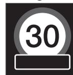
Ein Symbol für Zusatzschild in Form eines leeren Rahmens unter dem Geschwindigkeitssymbol im Kombinationsinstrument bedeutet, dass das RSI ein Zusatzschild mit zusätzlichen Informationen zur aktuellen Geschwindigkeitsbegrenzung erkannt hat.
