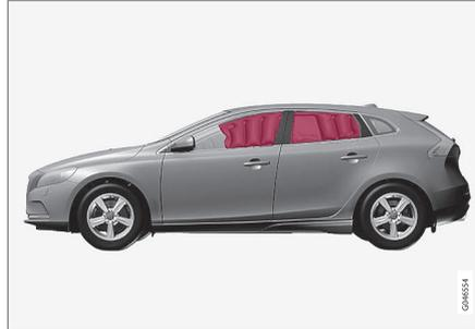
Die Kopf-/Schulterairbags IC (Inflatable Curtain) sind ein Teil des SIPS-Systems (S. 39). Sie sind entlang der Dachinnenseite auf beiden Seiten angebracht und helfen dabei, den Fahrer und die Mitreisenden auf den äußeren Sitzen des Fahrzeugs zu schützen. Bei einem ausreichend starken Aufprall reagieren die Sensoren und der Kopf-/Schulterairbag wird aufgeblasen.
