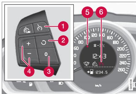
Tastenfeld des Lenkrads und Kombinationsinstrument in einem Fahrzeug **mit** Tempomat<sup>4</sup>.
