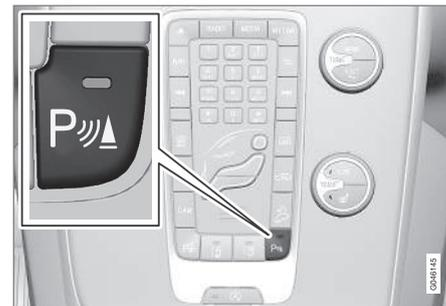
Ein/Aus der Sensoren der Einparkhilfe und von CTA.
