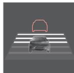
Es können verschiedene Zeitabstände zum vorausfahrenden Fahrzeug eingestellt und auf dem Kombinationsinstrument als 1–5 horizontale Linien angezeigt werden – je mehr Linien, desto größer der Zeitabstand. Eine Linie entspricht ca. 1 Sekunde zum vorausfahrenden Fahrzeug, 5 Linien ca. 3 Sekunden.
