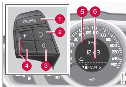
Tastenfeld des Lenkrads und Display in einem Fahrzeug **ohne** Geschwindigkeitsbegrenzung<sup>6</sup>.
