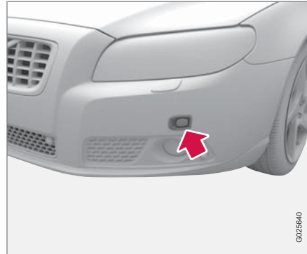
Steckdose für Motorheizung.
