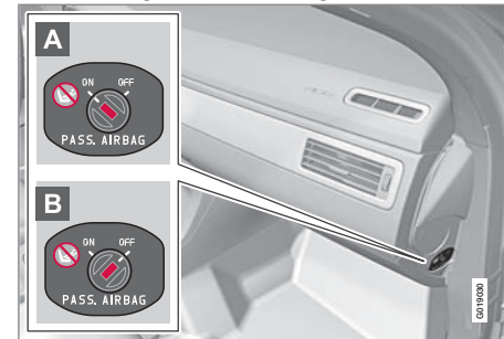
Position des Schalters.
