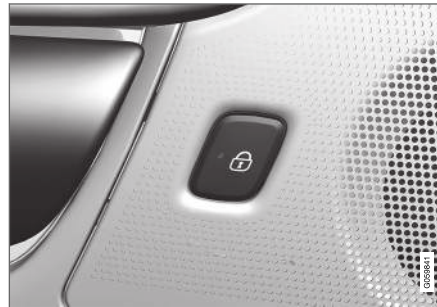
Verriegelungstaste mit Anzeigeleuchte an der Hintertür.
