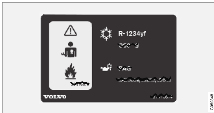
2 Aufkleber für Klimaanlage mit Kältemittel R1234yf.
