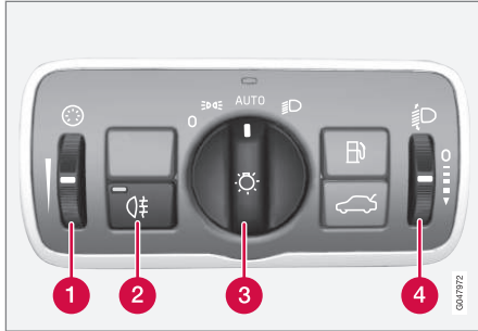
Übersicht Schalterfeld Beleuchtung.
