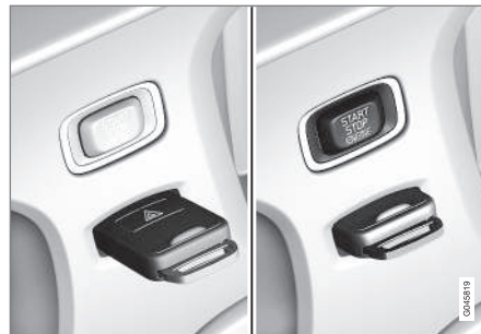
Zündschloss mit herausgezogenem/eingedrücktem Transponderschlüssel.
