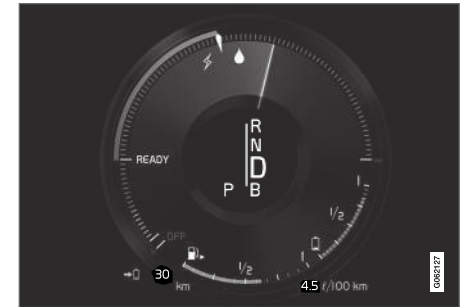
Fahrerdisplay bei Antrieb durch Elektro- und Verbrennungsmotor.
