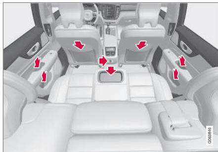
Ablagefächer in der Türverkleidung, Getränkehalter* an der Rückenlehne des mittleren Sitzplatzes, Einsteckfach* an den Rückenlehnen der Vordersitze und Steckdose in der Tunnelkonsole.
