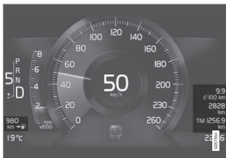
Beispiel für Bordcomputerinformation im 8-Zoll-Fahrerdisplay. Die Abbildung ist thematisch - je nach Fahrzeugmodell können die Einzelheiten unterschiedlich sein.
