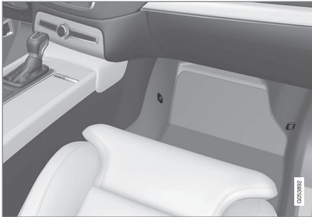
Lage der Befestigungspunkte für den Vordersitz
