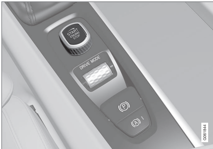
Startschalter auf der Tunnelkonsole.
