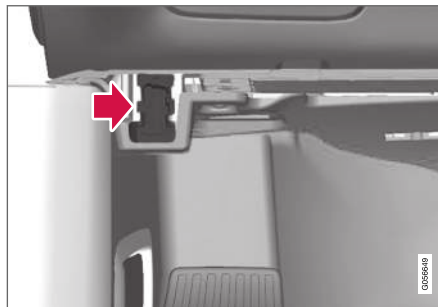
Diagnoseanschluss (On-board Diagnostic-Anschluss, OBDII) unter dem Armaturenbrett auf Fahrerseite.
