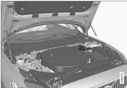
Die Unterstützungsbatterie befindet sich im Motorraum.
