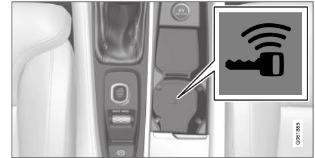
Lage des Schlüssellesegeräts in der Tunnelkonsole.
