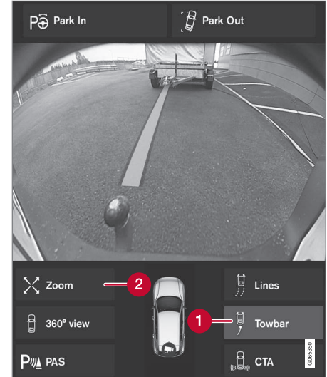
Anhängerkupplung mit Hilfslinie.
