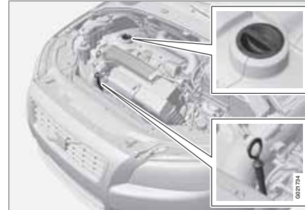
Messstab und Einfüllrohr, Benzinmotor.
