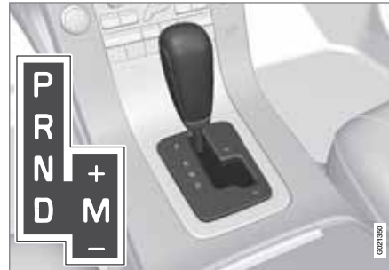
D: Automatische Gangstellungen. M (+/-): Manuelle Gangstellungen.
