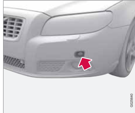
Steckdose für Motorheizung.
