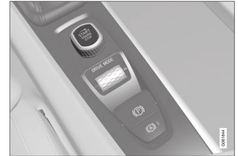
Startschalter auf der Tunnelkonsole.
