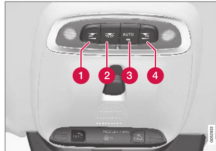
Bedienelemente in der Deckenkonsolle für vordere Leseleuchten und Innenbeleuchtung.
