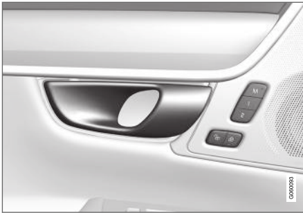
Griff zum alternativen Entriegeln der Tür.
