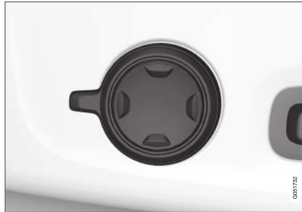
Seitlich am Sitzpolster angebrachter Multifunktionsschalter.
