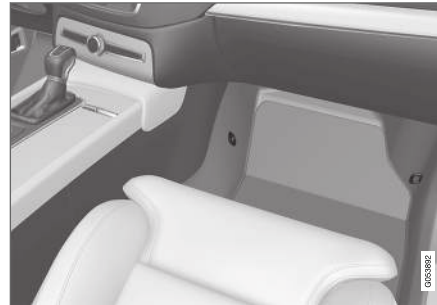
Lage der Befestigungspunkte für den Vordersitz
