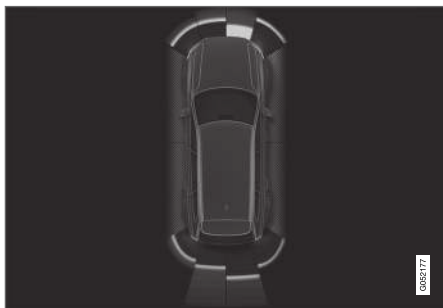
Displayanzeige mit Hinderniszonen und Sensorsektoren.
