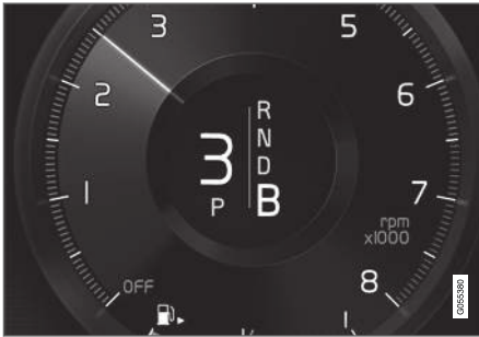
Schaltstellung B auf dem Fahrerdisplay.
