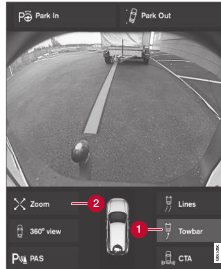
Anhängerkupplung mit Hilfslinie 123 .
