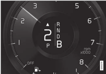
Schaltanzeige im Fahrerdisplay 2 .
