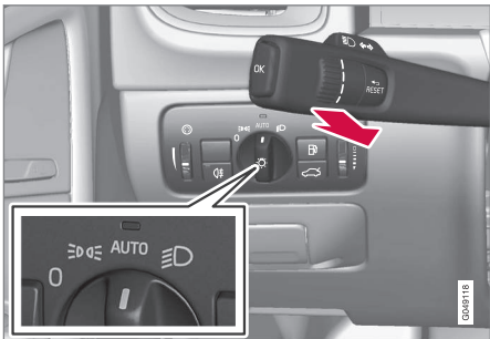
Lenkradhebel und Lichtschalter-Drehregler in Stellung AUTO .
