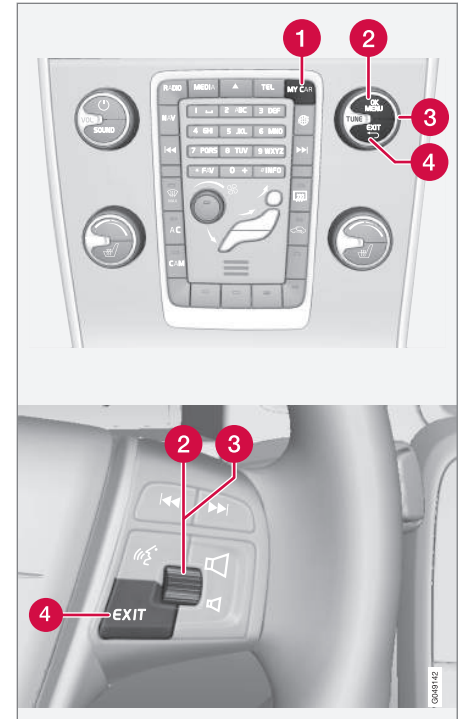
Bedienfeld in der Mittelkonsole und Tastenfeld am Lenkrad. Die Abbildung ist eine schematische Darstellung – je nach Ausstattung und
