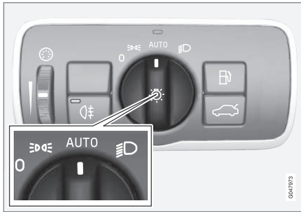
Drehregler des Lichtschalters in Stellung AUTO .
