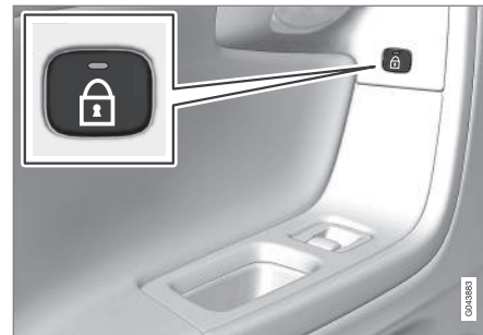
Die Lampe in der Taste leuchtet, wenn die Tür verriegelt ist.
