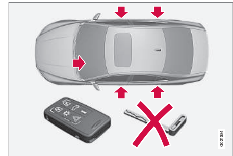
Verriegelungspunkte für Transponderschlüssel ohne Schlüsselblatt und aktiverter Geheimverriegelung.
