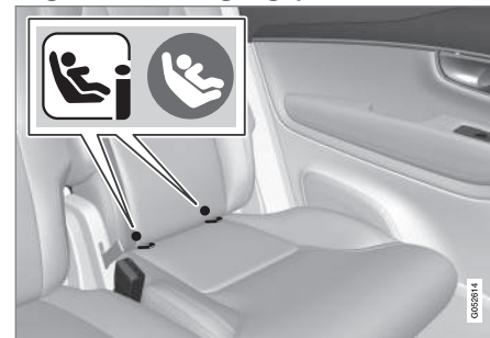
Lage der Befestigungspunkte in der zweiten Sitzreihe.
