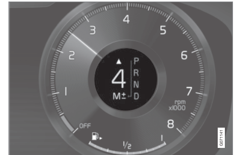
Schaltanzeige auf dem 12-Zoll-Fahrerdisplay bei großem Wählhebel*.
