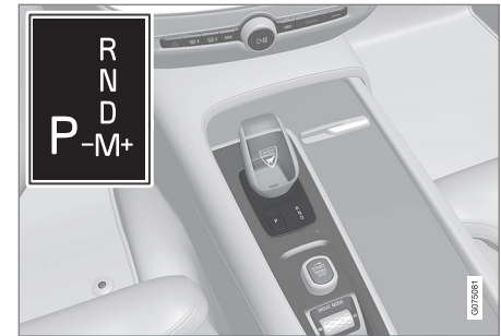
Kleiner Wählhebel und Schaltmuster auf dem Fahrerdisplay.
