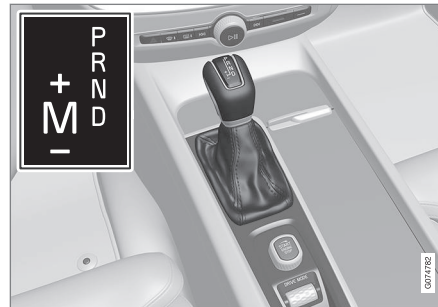
Großer Wählhebel und Schaltmuster auf dem Fahrerdisplay.
