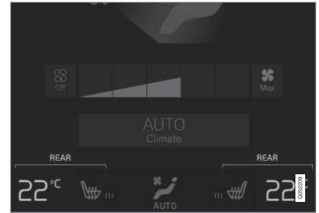
Temperaturtasten unter Klima im Fond in der Ansicht Klima.
