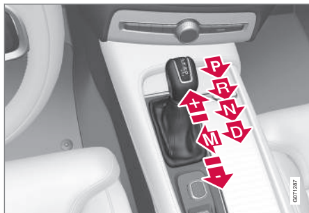
Übersicht über den großen Wählhebel und Schaltstellungen.
