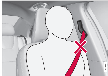
Falsch angelegter Sicherheitsgurt. Der Gurt muss an der Schulter anliegen.
