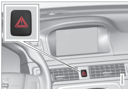
Taste für Warnblinkanlage.
