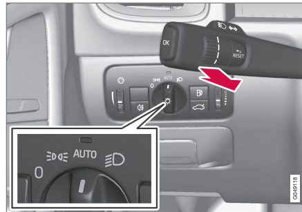
Lenkradhebel und Lichtschalter-Drehregler in Stellung AUTO .
