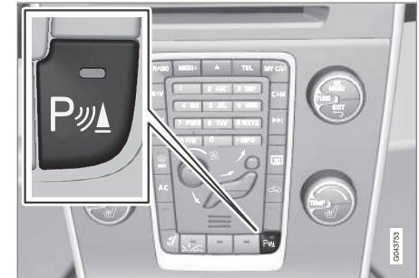
Ein/Aus für die Einparkhilfe.
