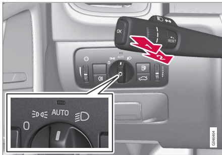
Lenkradhebel und Lichtschalter-Drehregler.
