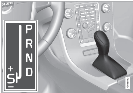
D: Automatische Gangstellungen. +S- : Manuelle Gangstellungen. S: Sportmodus*.
