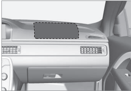
Position des Beifahrerairbags in Rechtslenkern.
