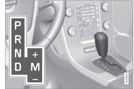
D: Automatische Gangstellungen. M (+/-): Manuelle Gangstellungen.
