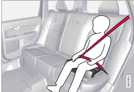
Korrekte Position, der Gurt verläuft oberhalb der Schulter.
