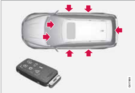
Verriegelungspunkte für Transponderschlüssel mit Schlüsselblatt.
