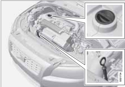
Messstab und Einfüllrohr.
