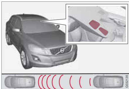
Sender- und Empfängerfenster des Lasersensors 1 .
