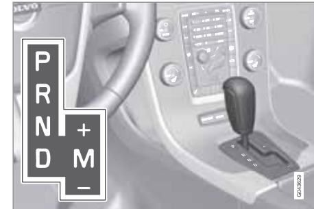
D: Automatische Gangstellungen. M (+/-): Manuelle Gangstellungen.
