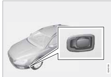
Steckdose für Motorheizung.
