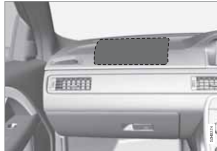
Position des Beifahrerairbags in Rechtslenkern.
