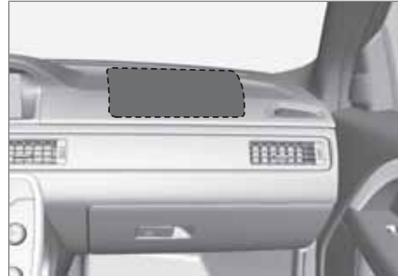
Position des Beifahrerairbags in Linkslenkern.
