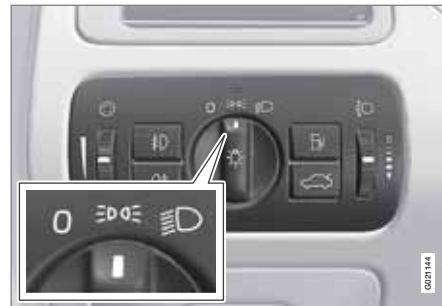
Lichtschalter in Stellung für Positionsluchten/Standlicht.
