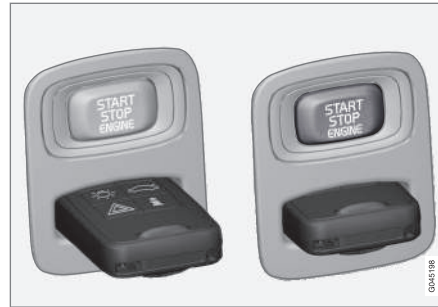
Zündschloss mit herausgezogenem/eingedrücktem Transponderschlüssel.
