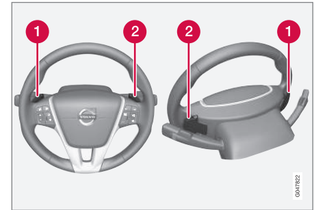
Die beiden "Schaltwippen" des Lenkrads.
