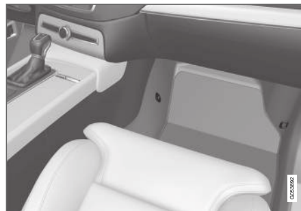
Lage der Befestigungspunkte für den Vordersitz
