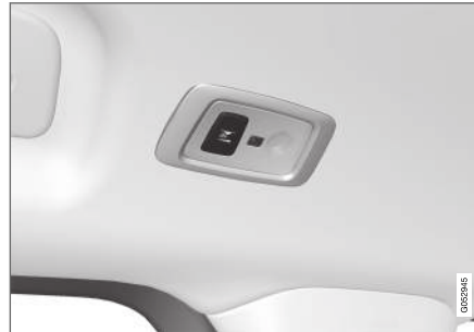
Fahrzeuge mit Panoramadach* verfügen beidseits des Dachs über je ein Leuchtenmodul.
