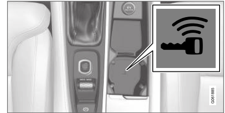
Lage des Schlüssellesegeräts in der Tunnelkonsole.
