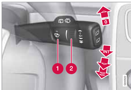
Wisch- und Waschanlage Windschutzscheibe.
