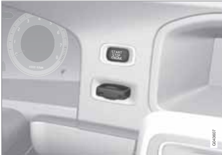
Zündschloss mit eingedrücktem Transponderschlüssel.
