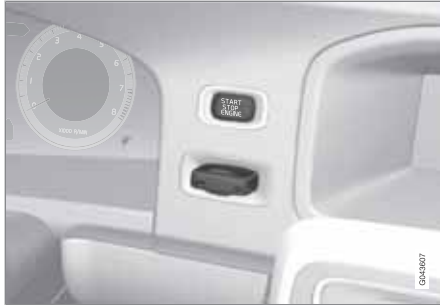
Zündschloss mit eingedrücktem Transponderschlüssel und START/STOP ENGINE -Taste.
