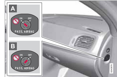
Position des Schalters.
