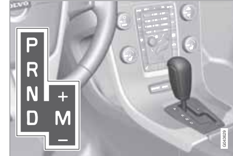
D: Automatische Gangstellungen. M (+/-): Manuelle Gangstellungen.
