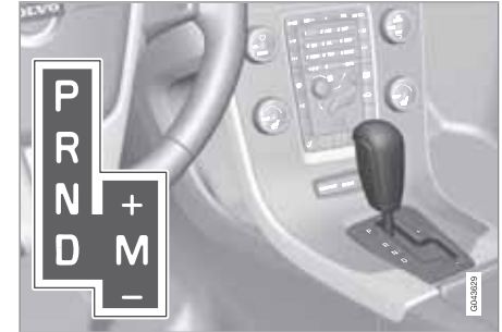
D: Automatische Gangstellungen. M (+/-): Manuelle Gangstellungen.
