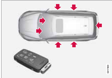
Verriegelungspunkte für Transponderschlüssel mit Schlüsselblatt.
