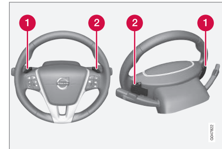
Die beiden "Schaltwippen" des Lenkrads.
