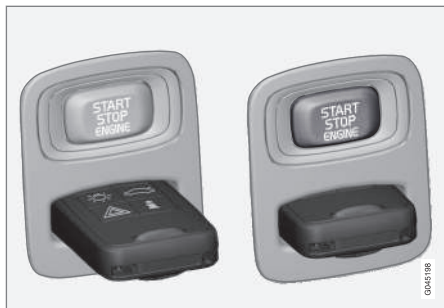
Zündschloss mit herausgezogenem/eingedrücktem Transponderschlüssel.
