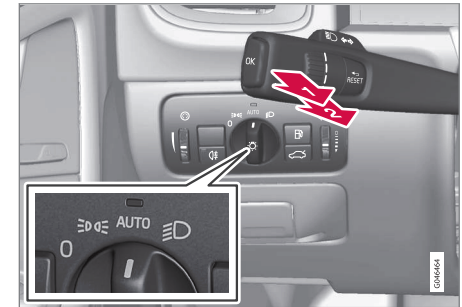
Lenkradhebel und Lichtschalter-Drehregler.
