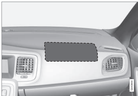
Position des Beifahrerairbags in Linkslenkern.
