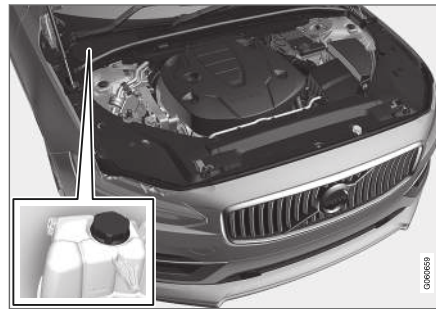
Ausgleichsbehälter der Kühlanlage, Rechtslenker.
