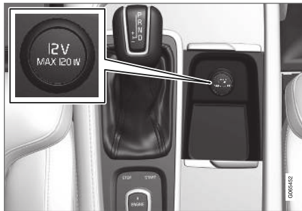
12-V-Steckdose in der Tunnelkonsole, vorn.
