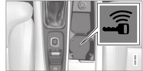
Lage des Schlüssellesegeräts in der Tunnelkonsole.
