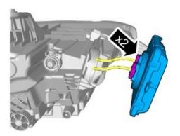
Die Steckverbinder lösen.
