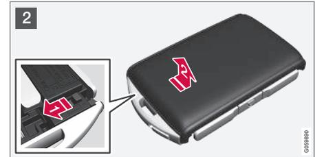
**2** ➔ Drehen Sie den Schlüssel um, führen Sie den Schalter zur Seite und schieben Sie die Abdeckung der Rückseite einige Millimeter nach oben.
