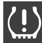
Kontrollieren und korrigieren Sie den Reifendruck, wenn das Kontrollsymbol des Systems aufleuchtet und die Meldung **Reifendruck niedrig!** angezeigt wird.
