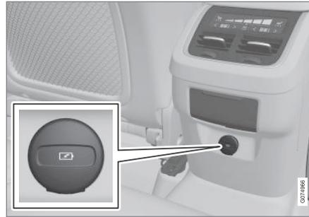
USB-Anschlüsse (Typ C) hinten auf der Tunnelkonsole beispielsweise für das Laden von Telefonen und Tablets<sup>6</sup>.
