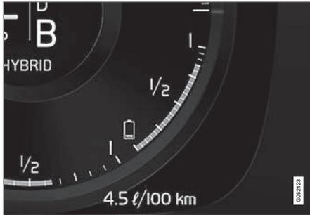
Die in der Hybridbatterie gespeicherte Energie wird vom Elektromotor, aber auch zum Kühlen oder Beheizen des Fahrzeugs genutzt. Der Bordcomputer berechnet, welche Strecke mit der in der Hybridbatterie gespeicherten Batterie ungefähr noch zurückgelegt werden kann.
