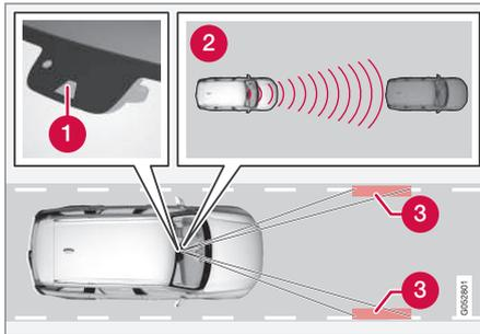
Die Kamera- und Radarsensoren messen den Abstand zum vorausfahrenden Fahrzeug und erkennen seitliche Fahrbahnmarkierungen.
