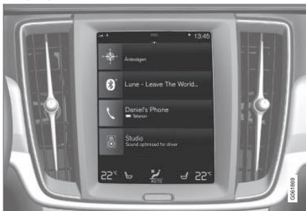
Viele der Hauptfunktionen des Fahrzeugs werden über das Display in der Mittelkonsole, einem berührungsempfindlichen Bildschirm (Touchscreen) gesteuert. Die Anzahl der physischen Tasten und Bedienelemente des Fahrzeugs ist deshalb minimal. Der Bildschirm kann mit oder ohne Handschuhe bedient werden.
