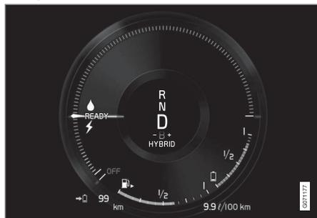
Das Fahrzeug wurde angelassen, steht aber; es wird keine Leistung angefordert.
