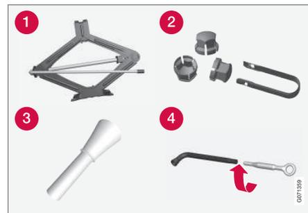
Alle Werkzeuge befinden sich im Schaumblock unter dem Ladeboden.
