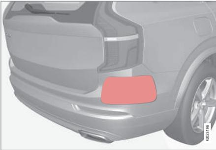
Platzierung der hinteren Radareinheiten. Halten Sie den markierten Bereich auf beiden Fahrzeugseiten sauber.
