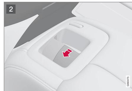
Bei Fahrzeugen ohne elektrische Umklappfunktion werden die Kopfstützen der äußeren Sitze mit dem innenliegenden Hebel oben am Sitz von Hand umgeklappt, siehe Abbildung
