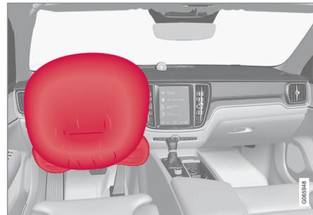
Lenkrad-Airbag und Knie-Airbag<sup>1</sup> am Fahrersitz.
