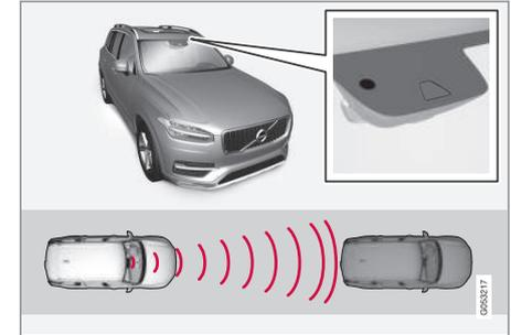
Die Kamera- und Radarsensoren messen den Abstand zum vorausfahrenden Fahrzeug.
