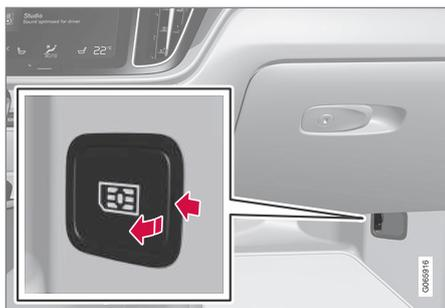
Setzen Sie Ihre SIM-Karte auf Beifahrerseite in die am Boden befindliche Halterung ein.
