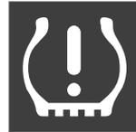
Dieses Symbol zeigt einen zu niedrigen Reifendruck an. Kontrollieren Sie in diesem Fall den Reifendruck im Center Display mit der App **Fzg.-Status**.
