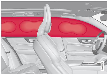
Diese sind rechts und links in den Dachhimmel eingelassen und schützen den Fahrer und die Insassen auf den äußeren Sitzplätzen. Die Verkleidung ist hier mit **IC AIRBAG** gekennzeichnet.
