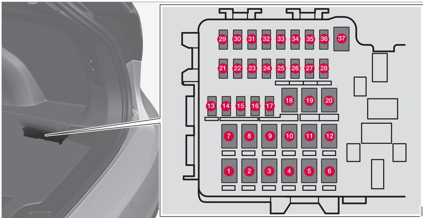
Der Sicherungskasten befindet auf der rechten Seite.
