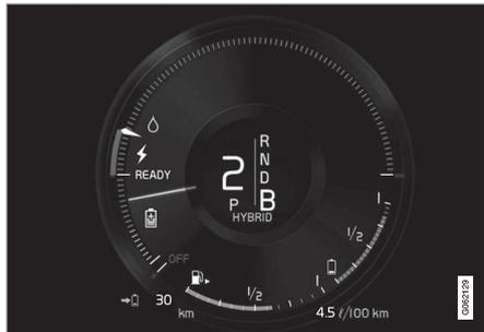
Anzeige im Fahrerdisplay bei Energierückgewinnung. Bei leichter Betätigung des Bremspedals oder beim Motorbremsen wird Energie für die Batterie regeneriert.
