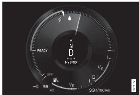
Der Elektromotor kann die angeforderte Motorleistung nicht liefern; der Verbrennungsmotor wird zugeschaltet.
