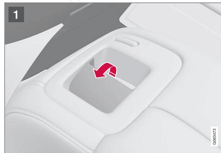
Bei Fahrzeugen mit elektrisch betätigtem\* Umklappen der Kopfstützen im Fond können die Kopfstützen der äußeren Sitze mithilfe der Handgriffe an der Oberseite der Sitze umgeklappt werden, siehe Abbildung **1**. Beachten
