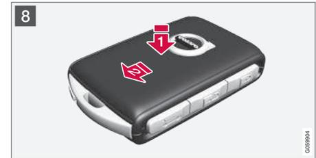
**8** **1** Transponderschlüssel umdrehen und die Abdeckung der Vorderseite wieder anbringen, indem sie nach unten gedrückt wird, bis ein Klickgeräusch zu hören ist.
