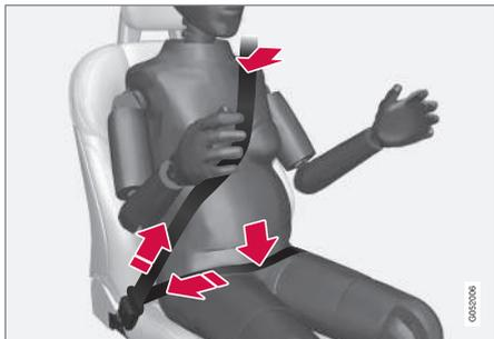
Der Sicherheitsgurt muss dicht an der Schulter anliegen, der Diagonaleil des Sicherheitsgurtes muss zwischen den Brüsten zur Seite des Bauches geführt werden.
