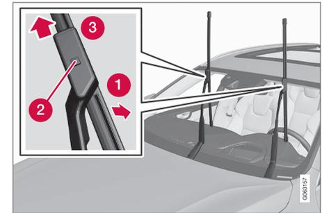
Den Wischerarm hochklappen, wenn er sich in Wartungsstellung befindet. Die Wartungsstellung über die Funktionsansicht im Center Display wird bei stillstehendem Fahrzeug und ausgeschalteten Scheibenwischern aktiviert bzw. deaktiviert.
