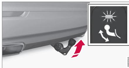
> Die Anhängerkupplung wird entriegelt und wird nach außen und unten geklappt – die Anzeileuchte blinkt orange. Die Anhängerkupplung kann nun weitergeführt und zum Einrasten gebracht werden.
