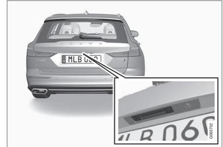
Die gummierte Druckplatte am Griff der Heckklappe dient ausschließlich der Entriegelung.
