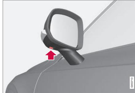
Die Seitenkameras befinden sich in den Seitenspiegeln.
