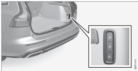
Öffnen Sie die Heckklappe. An der rechten Kofferraumwand befindet sich ein Schalter zum Ein- und Ausklappen der Anhängerkupplung. Damit die Anhängerkupplung ausgeklappt werden kann, muss die Anzeileuchte des Schalters orange leuchten.
