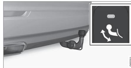
Führen Sie die Anhängerkupplung in ihre Endstellung und lassen Sie sie einrasten – die Anzeileuchte leuchtet konstant orange.
