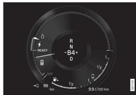
Das Fahrzeug produziert Strom für die Batterie, die Batterie wird geladen, z. B. bei einem leichten Druck auf das Bremspedal oder beim Motorbremsen bei der Bergabfahrt.
