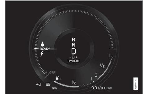
Die Hybridanzeige stellt in unterschiedlicher Weise das Verhältnis zwischen bereits aus dem Elektromotor entnommener und noch verfügbarer Leistung dar.
