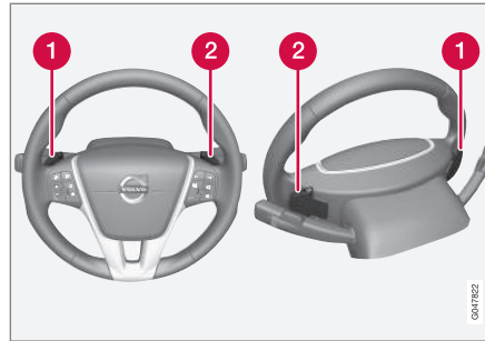
Die beiden "Schaltwippen" des Lenkrads.
