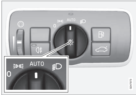
Drehregler des Lichtschalters in Stellung AUTO .
