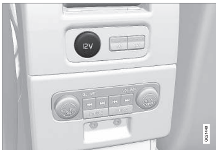
12-V-Steckdose in der Tunnelkonsole, Fond.
