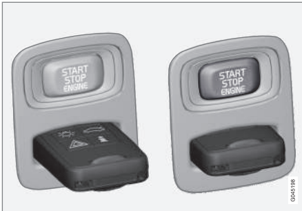
Zündschloss mit herausgezogenem/eingedrücktem Transponderschlüssel.
